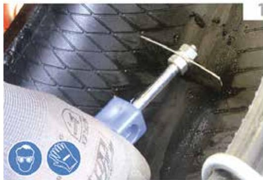
1. Rengør dækkets innerliner overfladen med TIP TOP Liquid buffer og en dækskraber.
