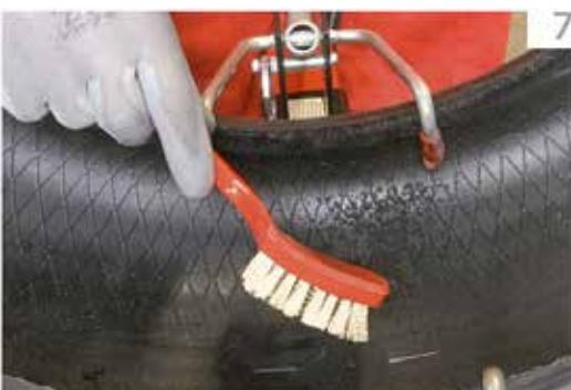
7. Brug en messingbørste til at rense den opraspede overflade. Brug ikke luftpistol.
