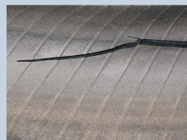
Innerliner brud igennem sidevægs forstærkning
