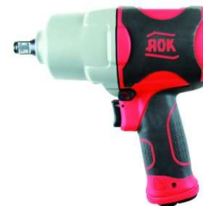
Art. 518 4264 1/2" SLAGNØGLE Med begrænset tilspænding 108 Nm Vægt, 1,95 Kg. 1085 Nm. 8 Bar
