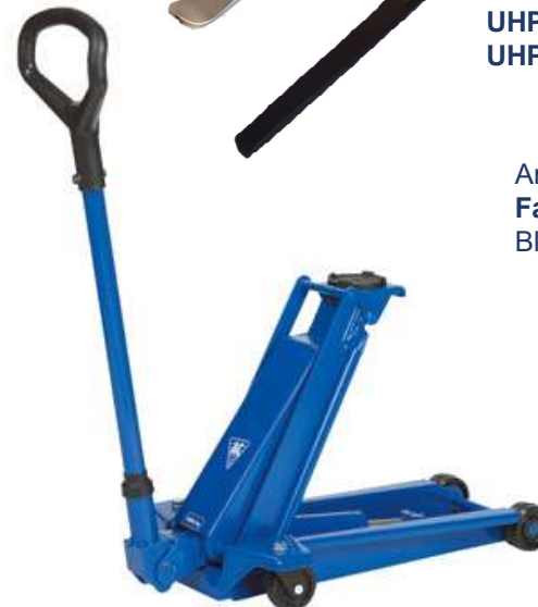
Art. 518 0420 AC VÆRKSTEDSDONKRAFT 4 PU hjul - Gummisaddel. Indsatshøjde 80 mm Løftehøjde 495 mm. Vægt: 31 Kg.
