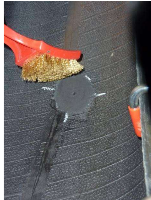
Skadesstedet børstes rent.
