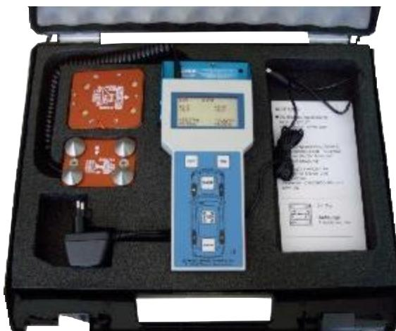
■ Med Romess elektronisk lutningsmätare kan fordonets nivå (markfrigång) mäts genom positionen på de tvärgående länkarmarna respektive axelns drivaxlar eller andra områden som stöder hjulvinkeln. Utöver de bestämda vinkelvärdena i grader kan man kontrollera en hjulinställningsskada. Rekommenderad av Mercedes Benz.
