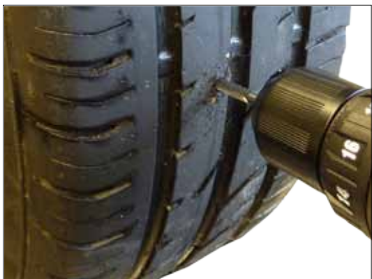
Skadeskanalen skadesbegrænses med 6 mm fræser, for MC/scooter dæk kun 4,5 mm. Kør fræseren frem og tilbage et par gange, så man er sikker på, at stålcorden er helt gennemboret.
