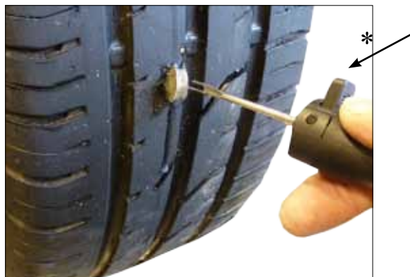
Indføringsnålen føres nu helt i bund. Tryk på udløseren* og træk nåle tilbage. "Proppen" sætter sig nu automatisk på plads i skadeskanalen
